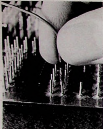
Afb. 3 Alle verbindingen worden gemaakt door middel van snoertjes, die zijn voorzien van schuifbusjes.
